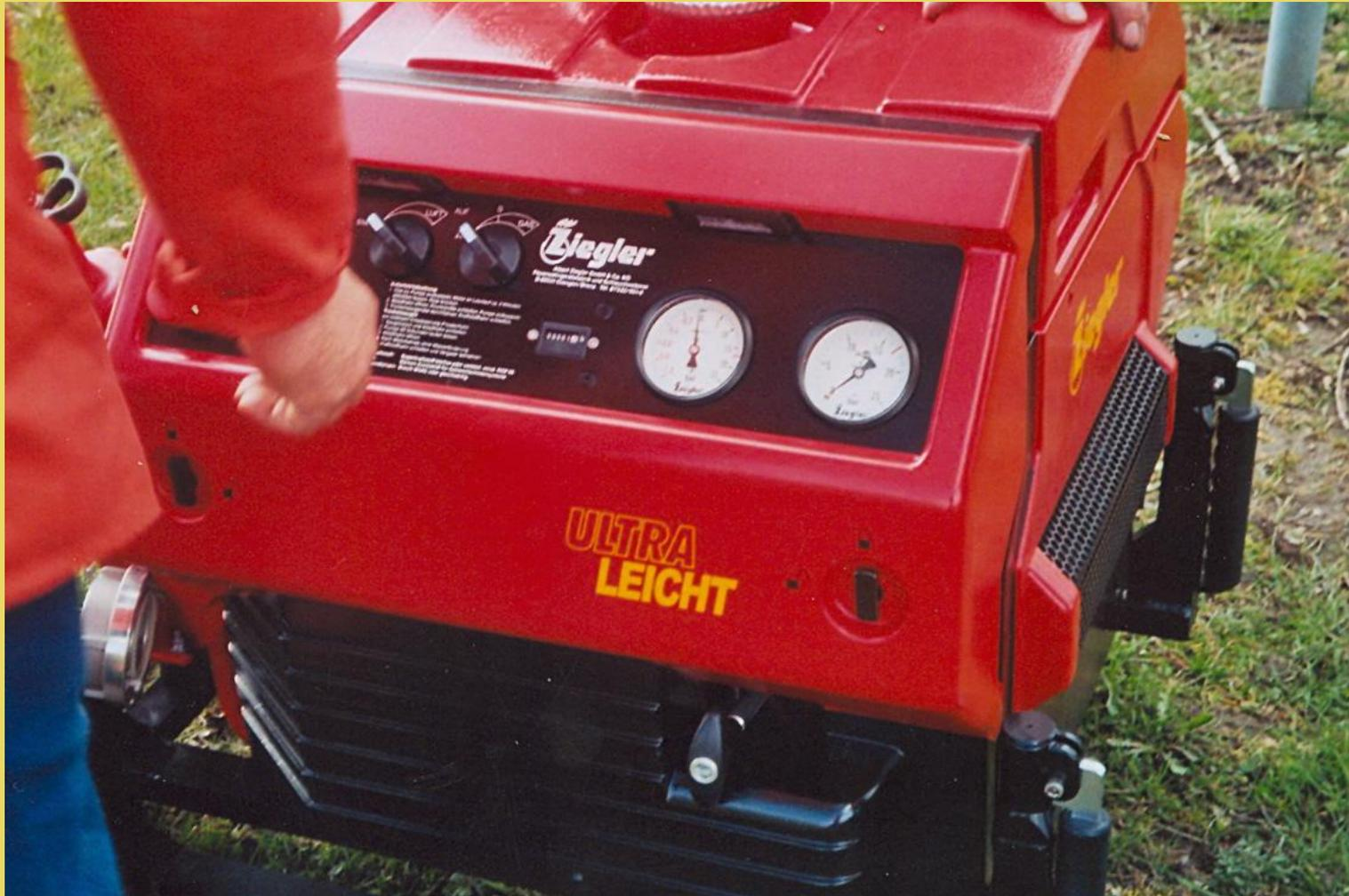
Die neue Tragkraftspritze TS 8/8 – Ziegler ultraleicht
